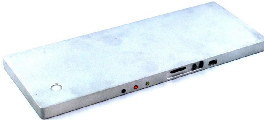
Das Radiometer TinyTracker ist ein Handmessgerät für die genaue Messung von Bestrahlungsprofilen und –dosis in Bestrahlungskanälen. Die Dosis wird dabei durch die Integration über die Bestrahlungsstärke berechnet. Die Messwerte werden auf einer SD Speicherkarte gespeichert. Die dazugehörige PC-Software erlaubt die Messwerte auszuwerten.
