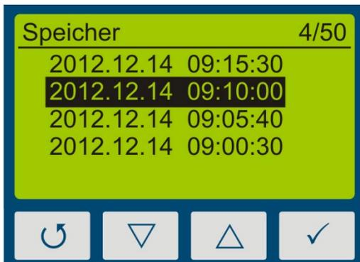
Mit den Tasten  $\nabla$  und  $\triangle$  wählen Sie die Messung aus. Bestätigen Sie mit  $\checkmark$ . Mit  $\curvearrowright$  zurück.
