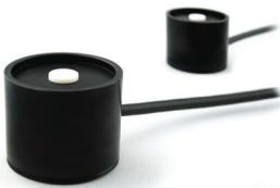
Die kalibrierten Radiometersensoren sind verfügbar für jede LED-Wellenlänge. Der integrierte Diffusor sorgt für die erforderliche Cosinus-Korrektur. Durch
