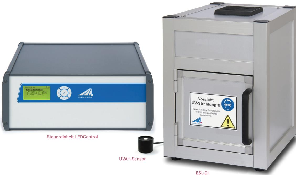
Durch moderne UV-LED-Technologie erreicht die Bestrahlungskammer BSL-01 eine extrem hohe Bestrahlungsstärke **bis zu 2400 mW/cm<sup>2</sup>**. Dies entspricht der 240-fachen Bestrahlungsstärke unserer klassischen Bestrahlungskammern. Als kompaktes Tischgerät eignet sich die UV-LED-Kammer BSL-01 damit hervorragend für die Härtung und Klebung in Laboren und Manufakturen.
