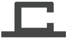
Die Grundplatte fixiert die Photometerzange stabil auf einem Tisch. Die standardmäßigen, schraubbaren Halter entfallen.
